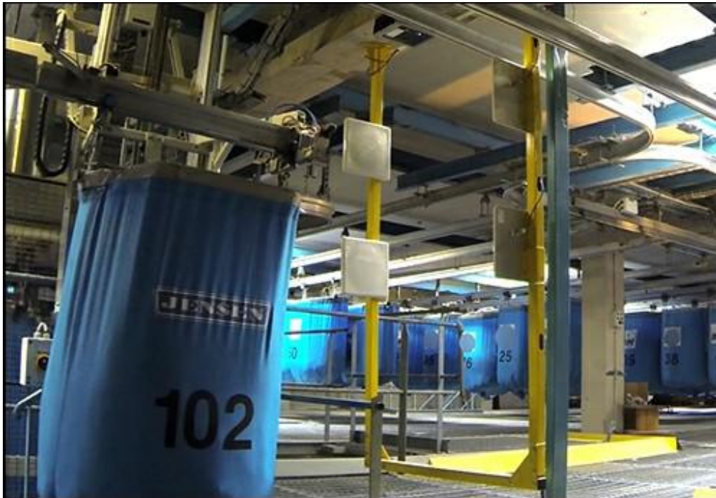
Las sábanas sucias se devuelven a BIH en bolsas grandes "sling", que se cuelgan en un transportador y se identifican cuando se ubican en una zona de lectura.
