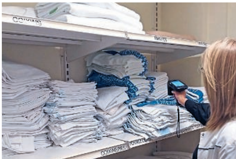
Erfassen und erleichterte Verfolgung der Textilstücke durch RFID.
